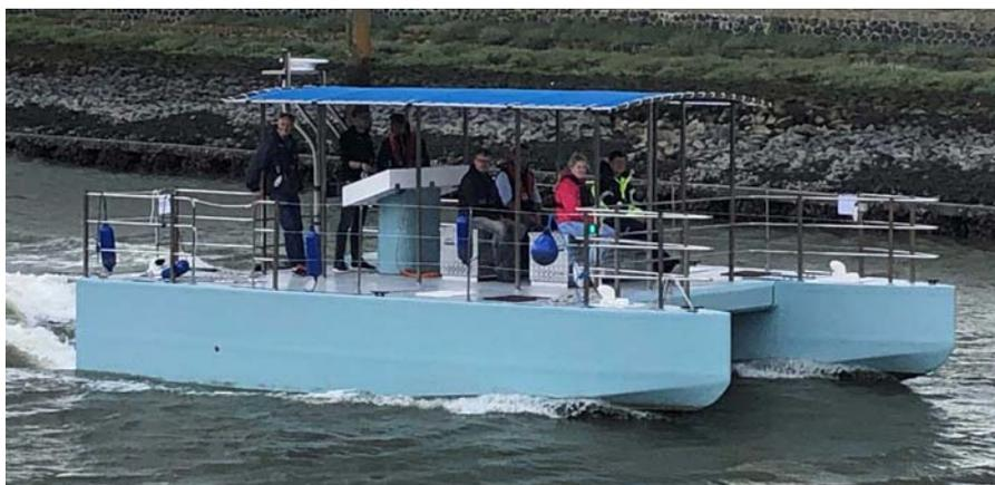
Der Katamaran fährt mit Batterien, per Brennstoffzelle soll die Reichweite noch erhöht werden
